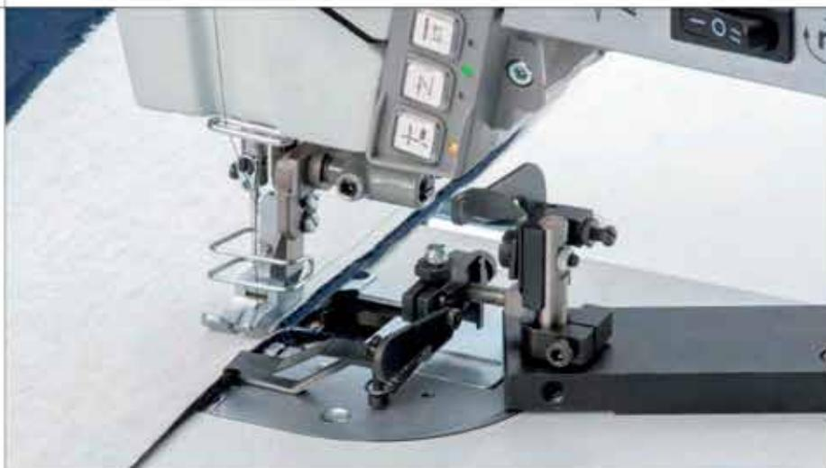
**272-740642-01 mit Nadeltransport und Kantenschneider**
