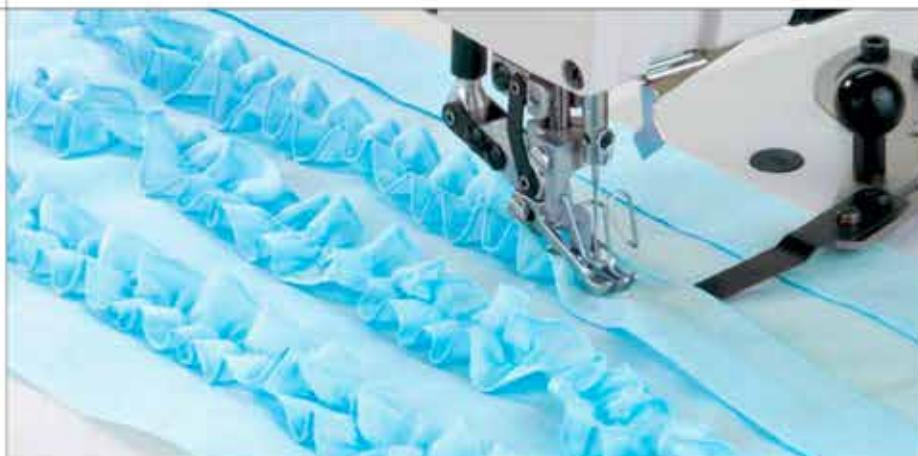
**275-140342-01 E3 / 275-142342-01 E3 – Kräuselarbeiten in Hemden und Blusen** mit Zwischenblech auf Schwenkschiene (N900 003601) montiert, zum besonders intensiven Einarbeiten von Mehrweite.
