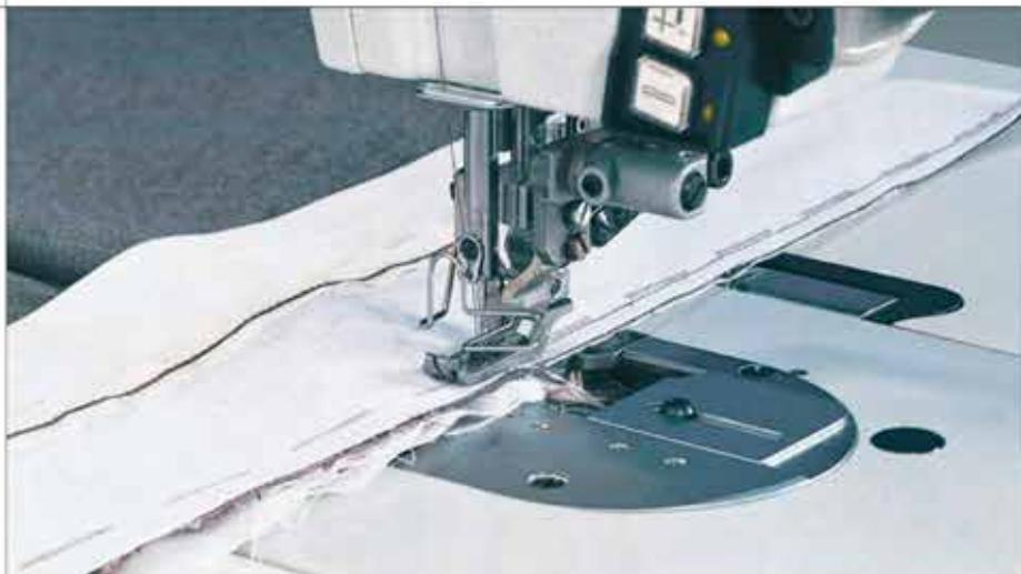
**275-740642-01 E104 (8 mm) – Bund aufnähen und gleichzeitiges beschneiden der Kante**
