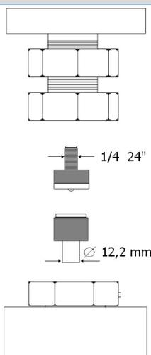
Le matrici (utensili) per la minuteria sono acquistabili dal fornitore di bottoni. Possibilità di avere portautensili a disegno.
