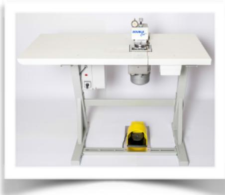
La **Double Cut** e' una macchina artigianale e interamente costruita a mano. Grazie alla regolazione dei piani indipendenti e alla sua precisione, al centesimo di millimetro, permette di aprire tessuti di qualsiasi spessore. La gamma di macchine consente di arrivare ad una profondit  di taglio max. di 60mm. Concepita e realizzata nel rispetto delle vigenti normative di sicurezza e certificata CE
