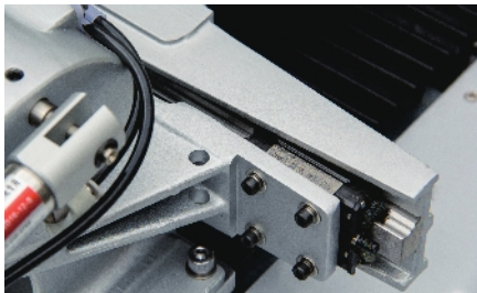
Unità complessiva con THK giapponese, collegamento del binario in sette pezzi (fila unica) Overall unit with Japanese THK, seven pieces(single row of ball) track linkage
