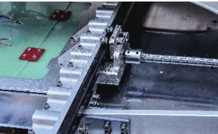
Trasmissione THK giapponese in direzione X, alta precisione, maggiore stabilità Japan's THK spline transmission in X direction, high precision, more stable operation
